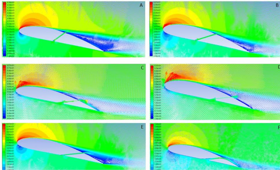
Figure 14: Velocity contours for A) 50-0-1-43, B) 30-0-1-43, C) 20-0-1.25-25, D) 20-0-0.75-58, E) 20-0-158, and F) 20-5-0.5-58 at  $14^{\circ}$  angle of attack
