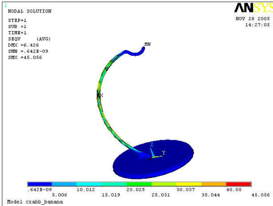
Figure 6. Team B Banana Hanger: von Mises Stresses
