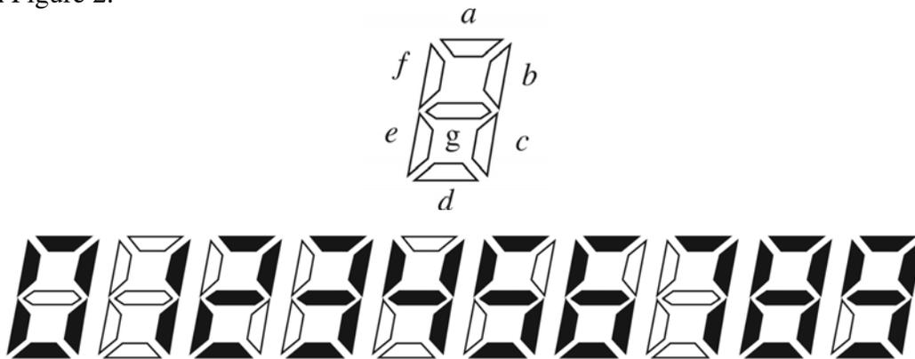
**Figure 1. Seven-Segment Display.**<sup>4</sup>
