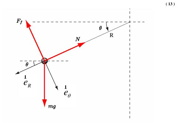
FIGURE 8 – FREE BODY DIAGRAM OF BEAD SLIDING ON A CIRCULAR TRACK
